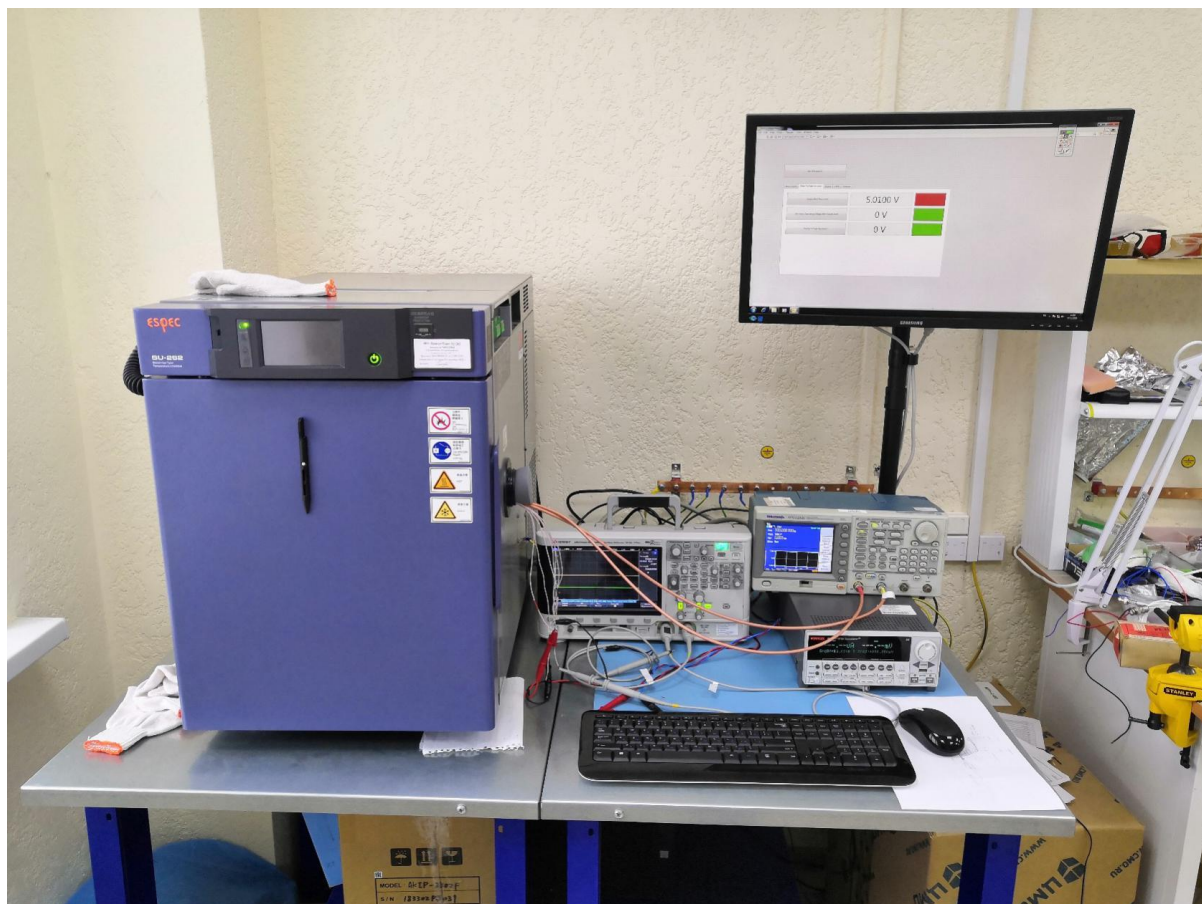
Испытательная камера тепла и холода – вид снаружи
